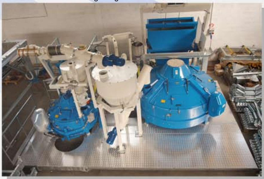
Plateforme malaxeur avec charpente galvanisée et plancher en aluminium anti glissement.
