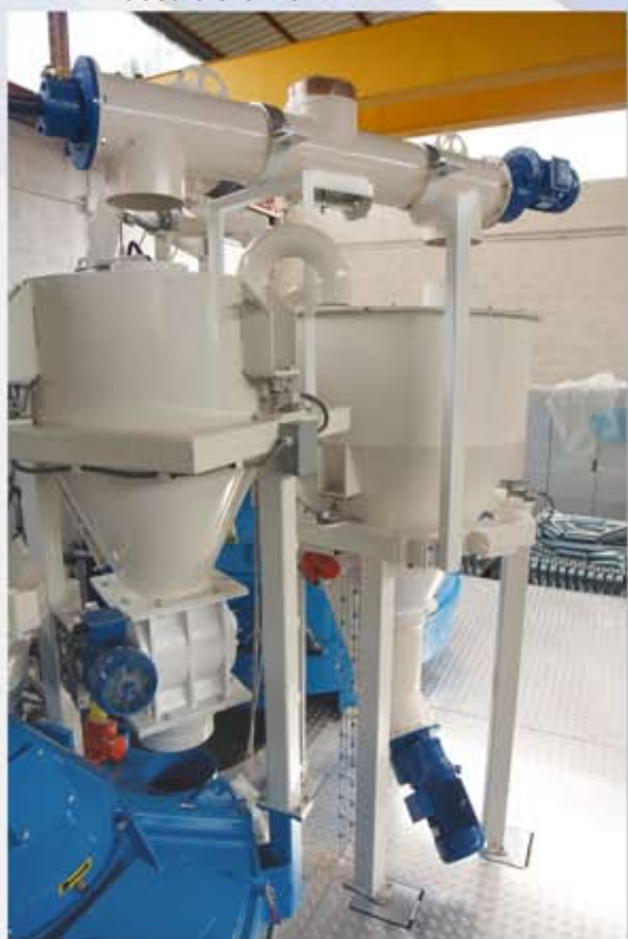
Bilance Cemento Cement dosing scale Bascule à ciment
