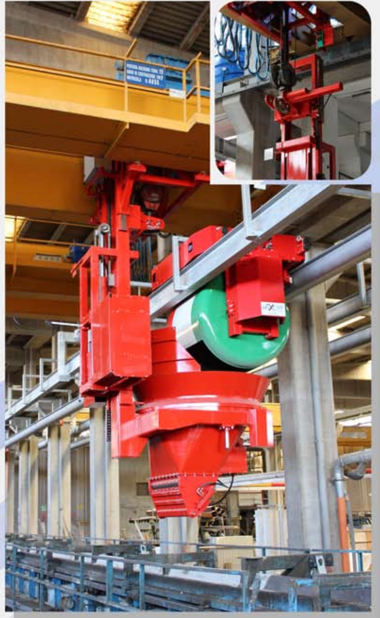
Benne getto per carriponte e carrigetto per solaio estruso Casting buckets for bridge cranes and casting cranes Bennes du béton pour ponts roulant et ponton roulant de colée
